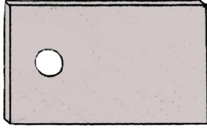
Mit einem großen Bohrer in der exakten Größe ein Loch in die Front bohren. Oder vorzeichnen und viele kleine Löcher bohren, bis der Kreis herausbricht. Dann glatt schleifen.
